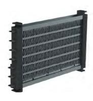
Нагревательные регистры или ребристые нагреватели на основе термисторов с положительным температурным коэффициентом (РТС) применяются для нагрева воздушного потока. Эффект автоматического ограничения температуры, свойственный РТС-термисторам, является гарантией высочайшей эксплуатационной безопасности.
