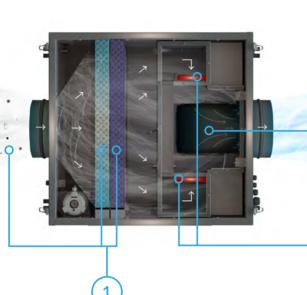
Вентилятор подаёт очищенный и нагретый воздух в воздуховод
