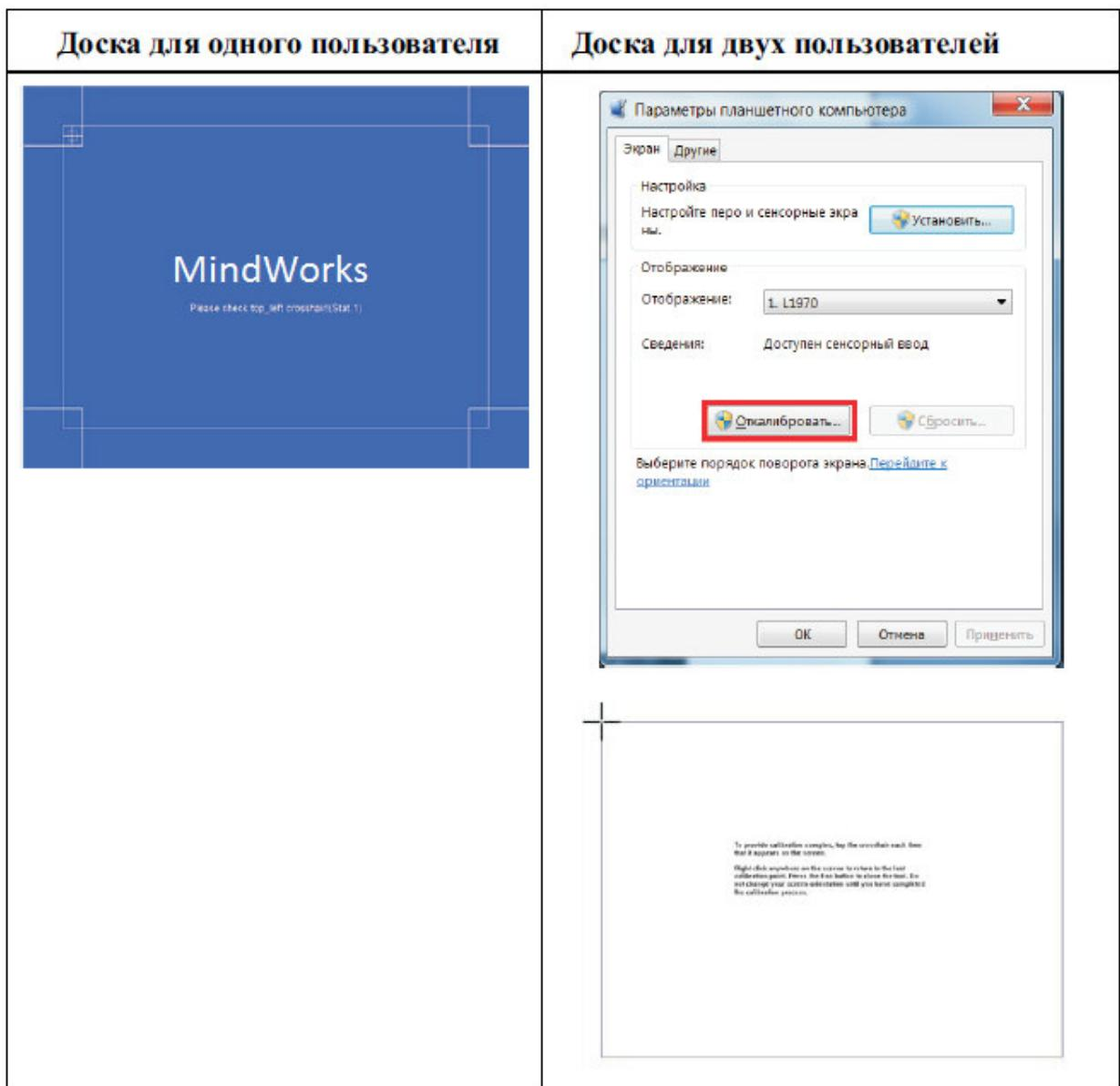
**Установка:** При переключении между режимами одного касания (для одного пользователя) и MultiTouch (для одновременной работы нескольких пользователей) пиктограмма на панели задач меняет свой цвет.
